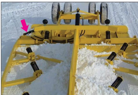
Le système de balancier latéral inclinable vers la gauche ou la droite. (Modèle XT ) Permet d'uniformiser la hauteur du sentier lorsque l'on élargit celui-ci. Permet aussi de garder le sentier plus élevé vers l'extérieur des courbes.
