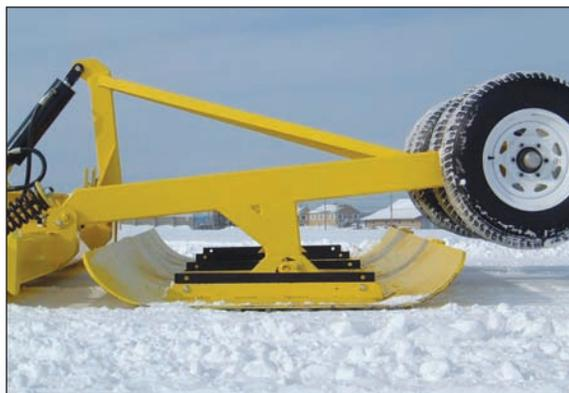
Le plateau compacteur est monté sur pivot permettant de demeurer horizontal peu importe la hauteur des couteaux arrière. (séries LN et CL)
