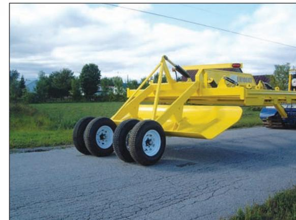
Système de levage à 4 roues pour plus de stabilité et offrant plus de portée sur le sentier lorsque le surfaceur est levé. De plus, advenant une crevaison, il est possible de continuer sans inconvénients. (séries LN et CL)
